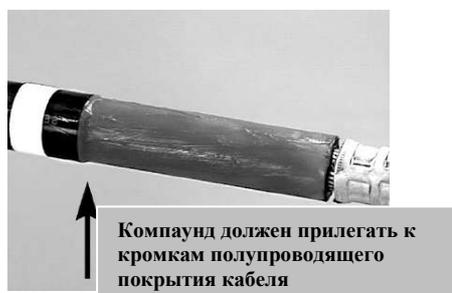
**Компаунд прилегает к кромкам полупроводящего покрытия кабеля**
