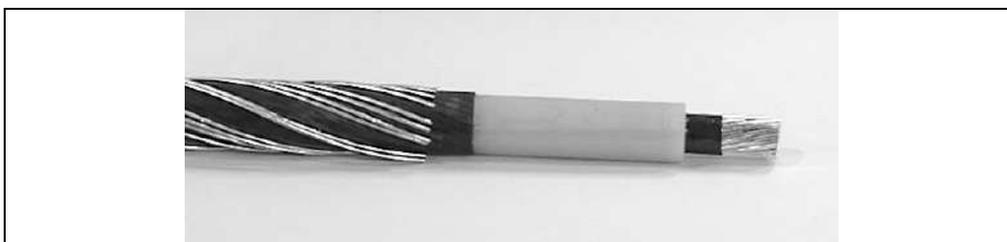
**Силовой кабель типа CN (CN - Concentric Neutral, с концентрично расположенным проводом нейтрали)**
